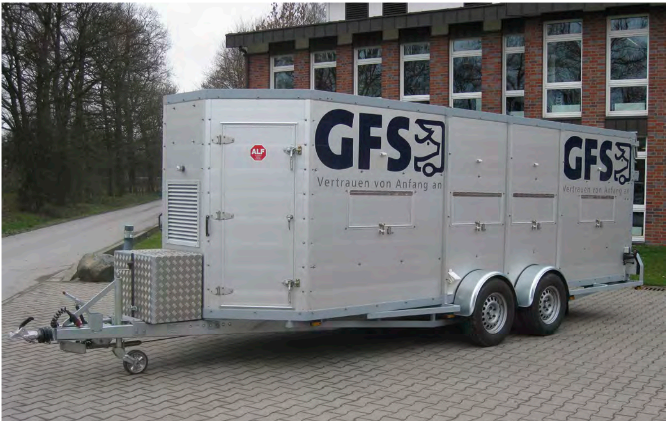
Abbildung 1: GFS-eigener Eber-Transportanhänger mit UV-Zuluft-Entkeimung. Bildquelle: GFS
